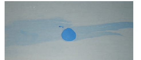
Mürekkep damlası kalıyor ise düşük kaliteli yüzey
